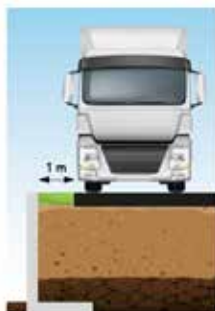
DLF10GS charges standard 40 kN/m 2 à une distance de 1 m du bord équivalent du case de charge LM1 selon NBN EN 1991-2
