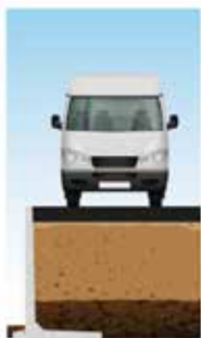
DLF10GSZ gelijkmatig verdeelde overlast 25 kN/m 2
