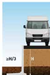
DLF10GSRZ gelijkmatig verdeelde overlast 25 kN/m 2
