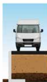
DLF10GS gelijkmatig verdeelde overlast 25 kN/m²
