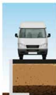
DLF10GS gelijkmatig verdeelde overlast 25 kN/m 2
