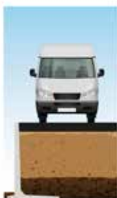
DLF10GSZ gelijkmatig verdeelde bovenbelasting 25 kN/m 2
