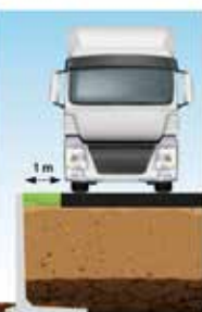
DLF10GSZ gelijkmatig verdeelde bovenbelasting 40 kN/m 2 op randafstand 1 m equivalent aan belastingsmodel LM1 volgens NEN EN 1991-2
