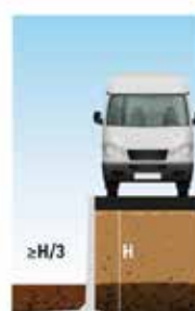
DLF10GSRZ gelijkmatig verdeelde bovenbelasting 25 kN/m 2
