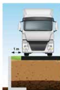
DLF10GS gelijkmatig verdeelde bovenbelasting 40 kN/m 2 op randafstand 1 m equivalent aan belastingsmodel LM1 volgens NEN EN 1991-2
